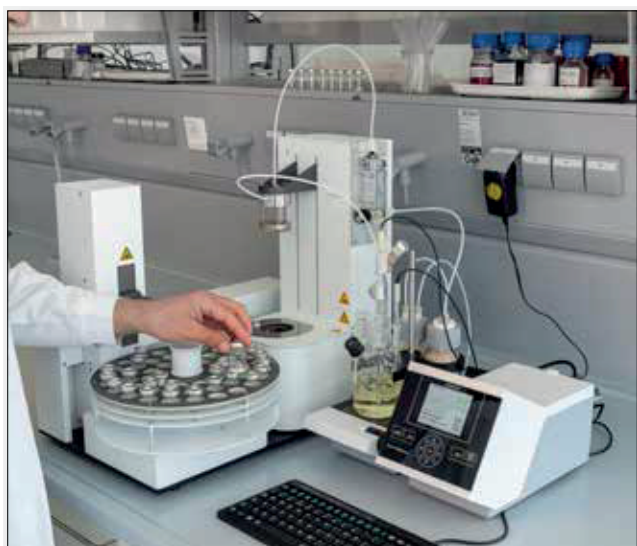
Titrateur TitroLine ® 7500 KF Trace avec Four KF Head - space TO 7280 et passeur d'échantillon TW 7650
